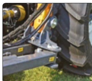
Гидравлический цилиндр бокового смещения, расположенный внутри параллельных рычагов
